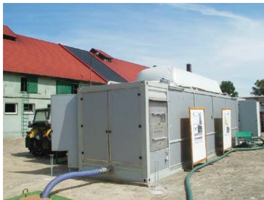
Fot.7. Kontenerowa biogazownia – Instytut Technologiczno-Przyrodniczy Poznań
