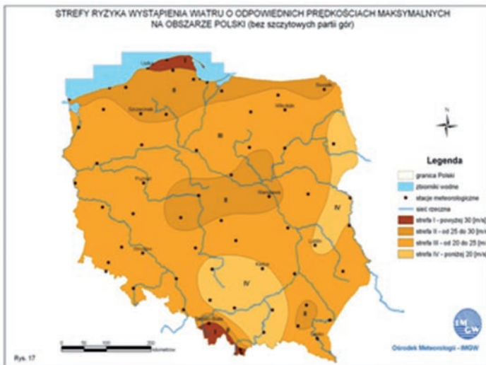
Strefy ryzyka wystąpienia wiatru o maksymalnych prędkościach na obszarze Polski. Źródło: IMGW
