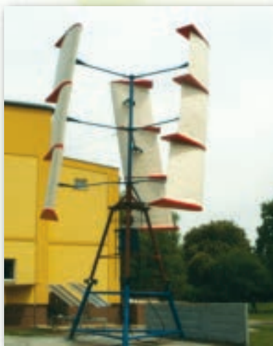
Fot. 15. Mała elektrownia wiatrowa o pionowej osi obrotu, ITP Poznań
