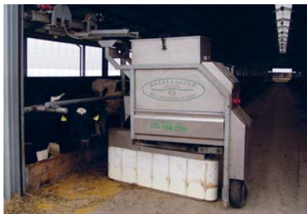
Fot. 7. Różne roboty do podgarniania paszy (samodzielny i szynowy)
