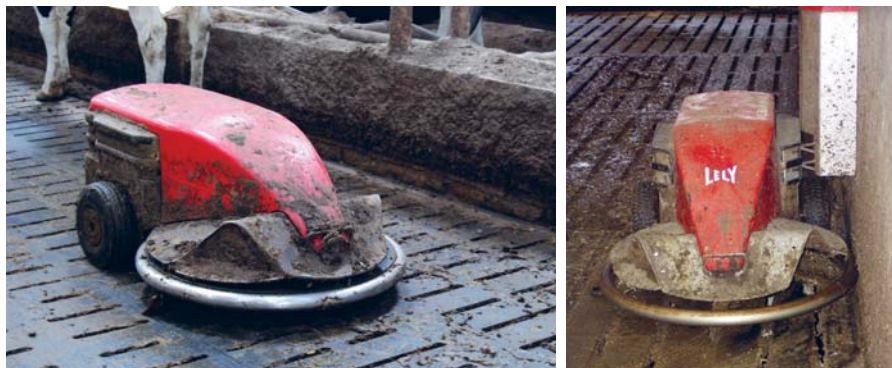
Fot. 6. Robot Discovery w akcji sprzątania i w stacji dokowania
