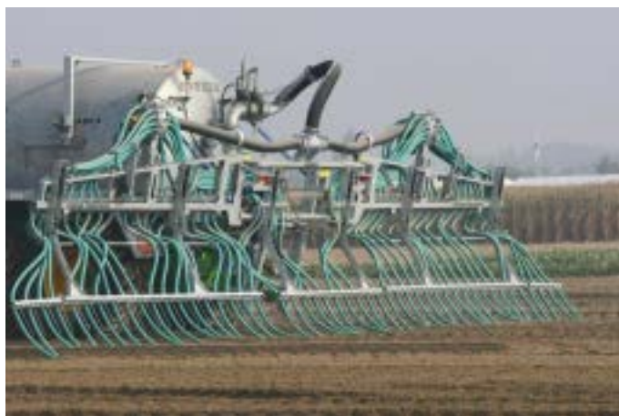
Fot. 3. Wóz asenizacyjny do aplikacji płynnych nawozów naturalnych przystawką z węzami wleczonymi [Werktuigendagen, 2009]
