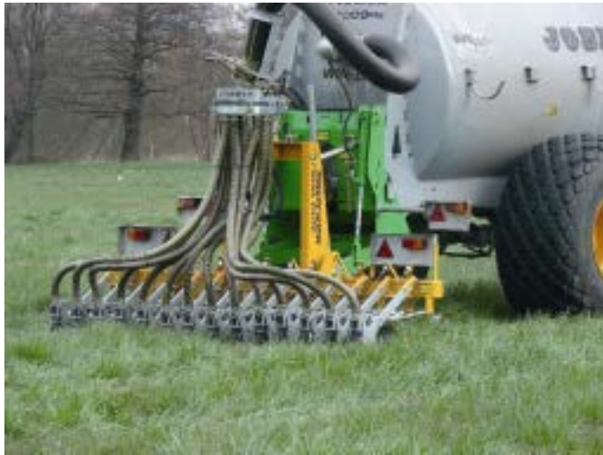
Fot. 1. Wóz asenizacyjny z aplikatorem do płytkiego wtryskiwania płynnych nawozów naturalnych (system firmy Joskin) (fot. P. Nawalany)
