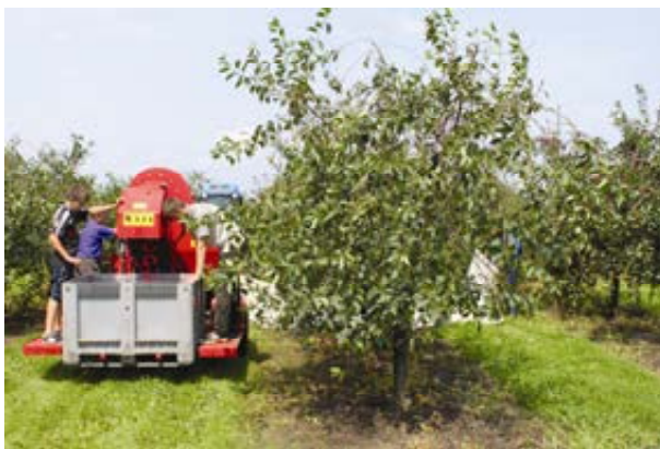
Zdj. 2. Otrząsarka z plachtami w sadzie
