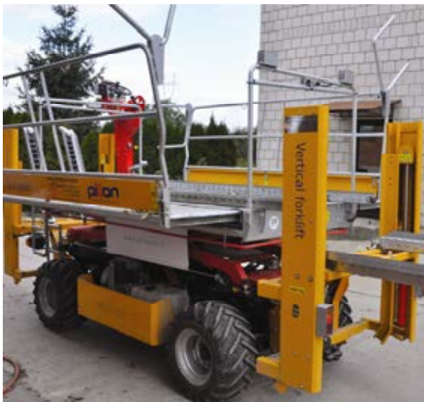
Zdj. 5. Platforma samobieżna z szerokimi możliwościami oszczędności pracy ludzkiej
